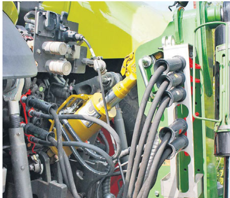
Nicht nur zwischen Traktor und Maschine wirken sich starke Schläge negativ aus und sollten deshalb abgefedert werden.
